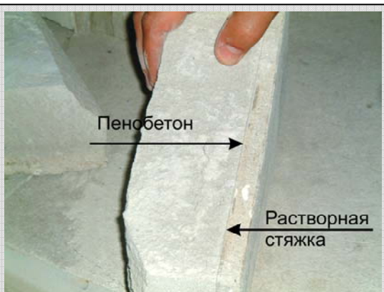
Образец для контроля качества пенобетона и раствора стяжки
