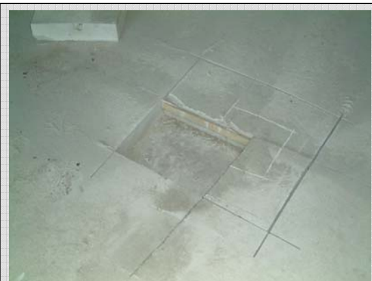
Вырезка контрольных образцов из конструкции пола
