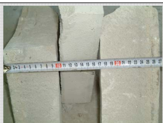
Различие толщин пенобетонных слоев за счет выравнивания основания пола
