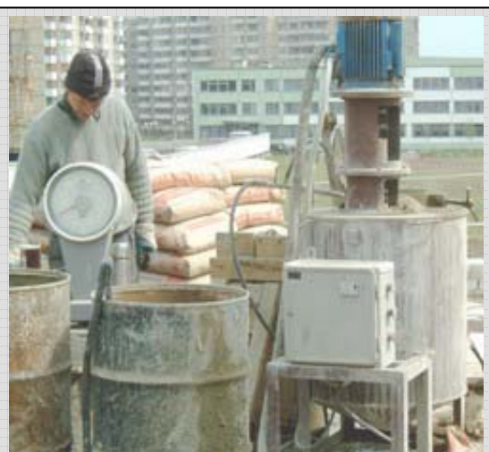
Контроль средней плотности пенобетонной смеси
